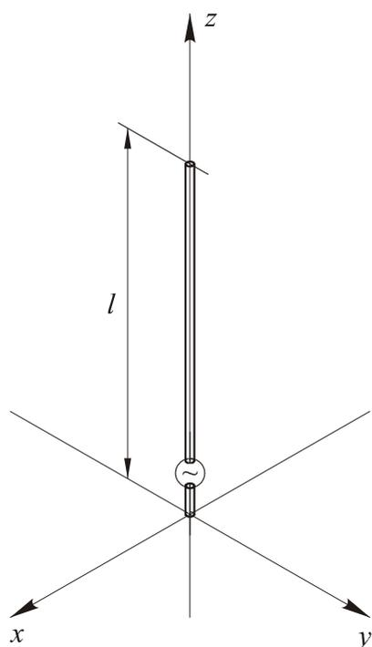
Рис. 1.2. Несимметричный вибратор
