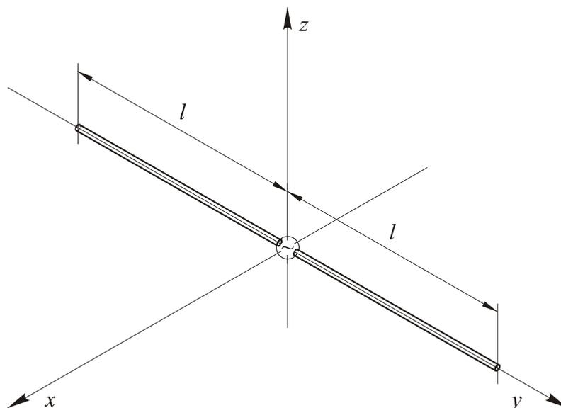
Рис. 1.1. Симметричный вибратор
