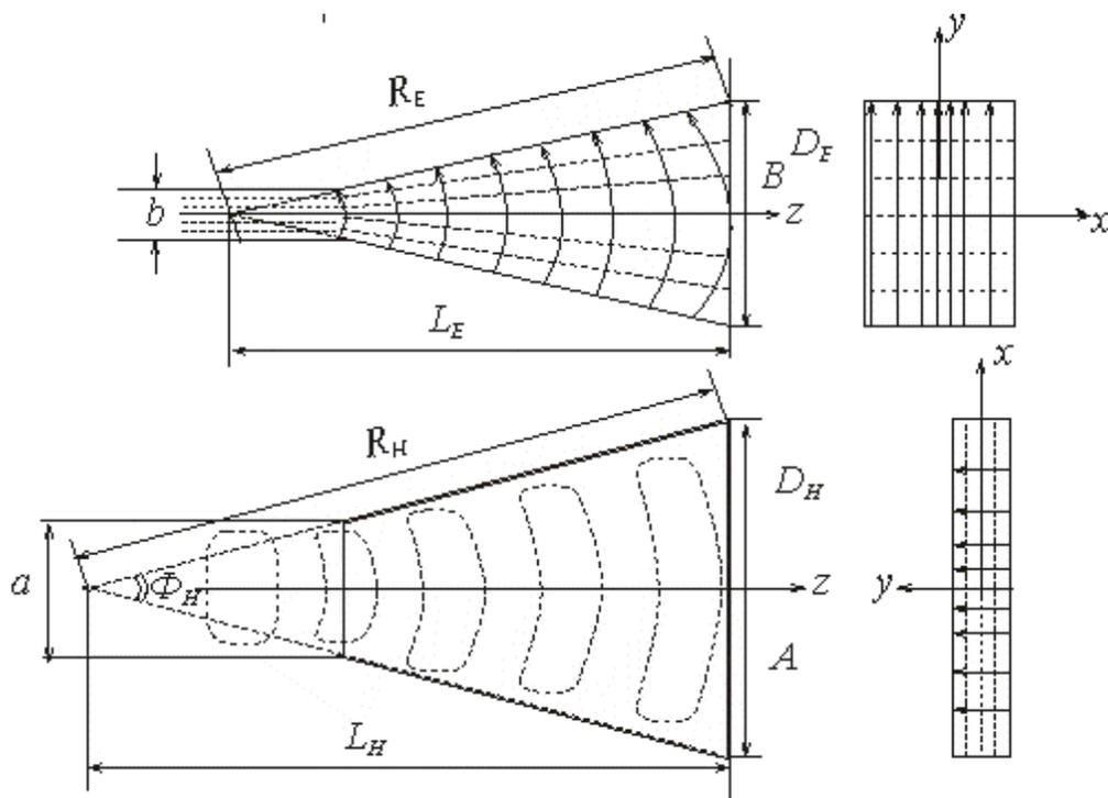
Рис. 3.1. Структура поля в E-плоскостном и в H-плоскостном секториальных рупорах
